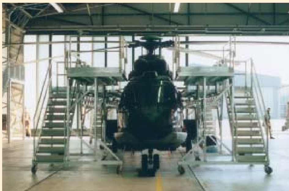
Servisní stanoviště pro vrtulníky
